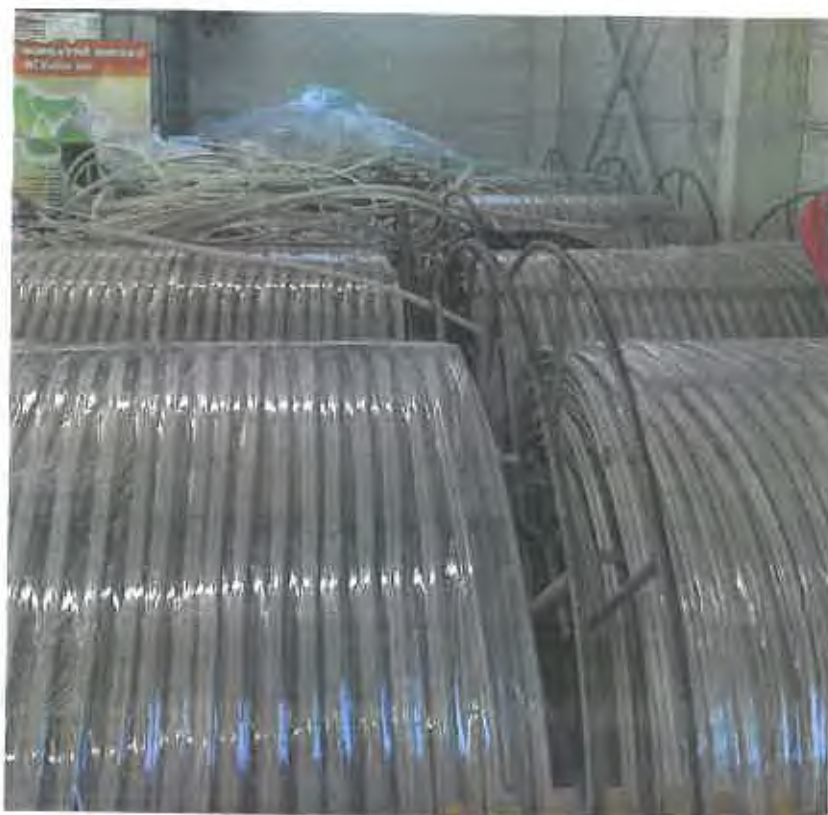
Obr. č. 1 Potrubné rošty navinuté na navijacích bubnoch
