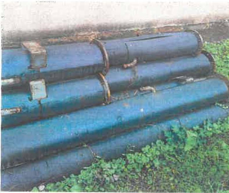
Obr. č. 2 Zberače s namontovanými vývodmi pre rozdeľovače
