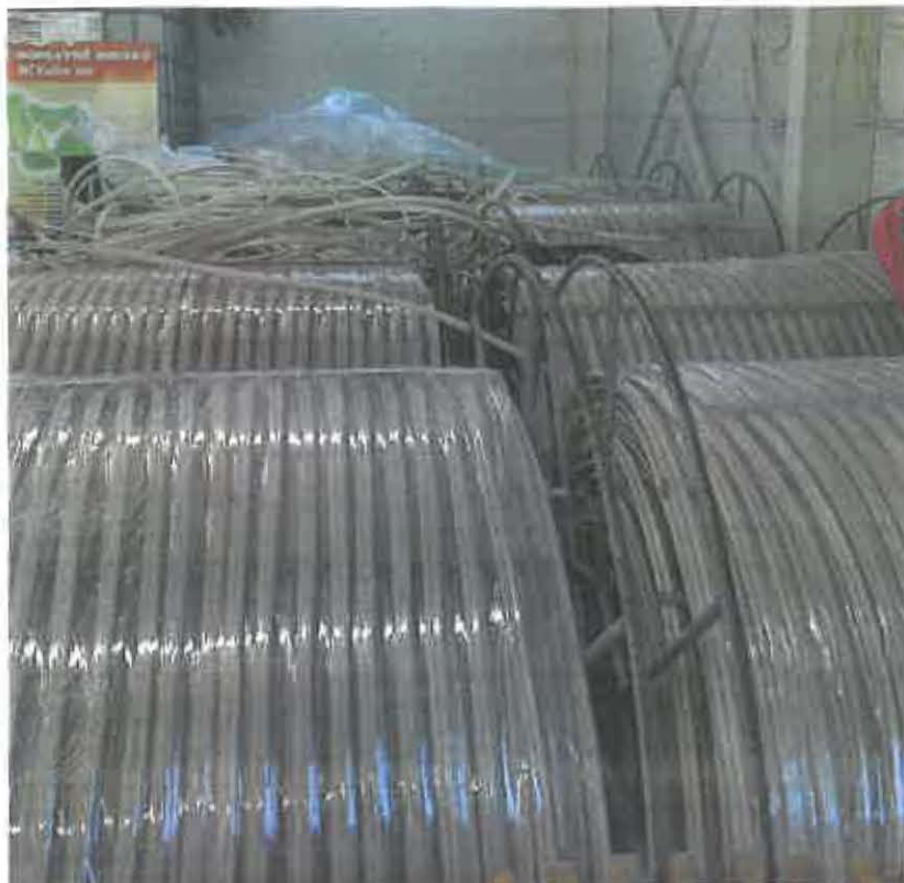
Obr. č. 1 Potrubné rošty navinuté na navíjacích bubnoch
